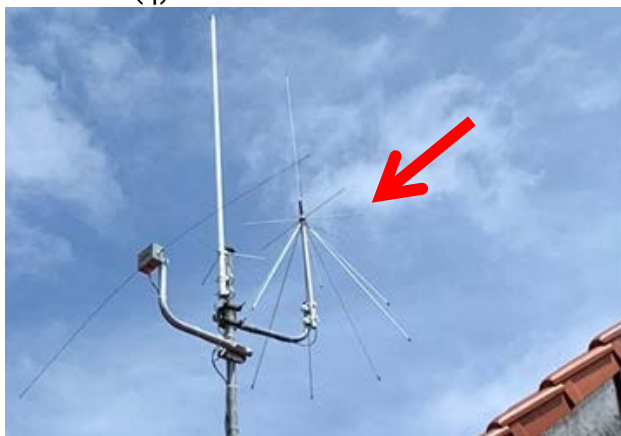
Mit der Antenne ganz rechts lassen sich die Passiv-Signale empfangen
