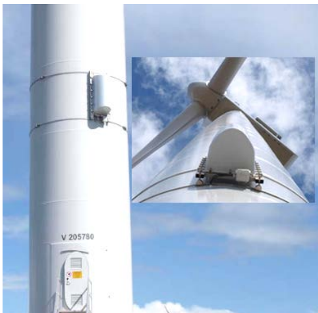
Antenne des Passiv-Radars an einer Windkraftanlage www.dirkshof.de/passiv-radar-system www.passiv-radar.de
