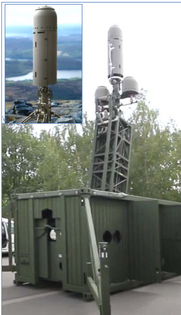
Militärisches Passiv-Radar der tschechischen Firma „ERA“ Es handelt sich um einen Prototyp, der in einem transportablen Container verbaut ist.
